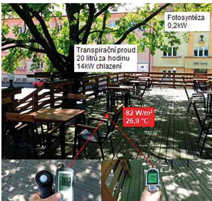
Obr. 2. Povrchové teploty a intenzitu slunečního záření lze snadno měřit cenově dostupnými přístroji. Intenzita slunečního záření na osluněném chodníku je 877 W.m -2 a povrchová teplota 51,2 °C. Ve stínu stromu je intenzita slunečního záření 82 W.m -2 a povrchová teplota 26,9 °C. Při transpiračním toku 20 litrů za hodinu chladí strom sebe a své okolí výkonem 14 kW. Sluneční energie uložená ve vodní páře se uvolní na chladných místech při srážení vodní páry zpět na vodu.
