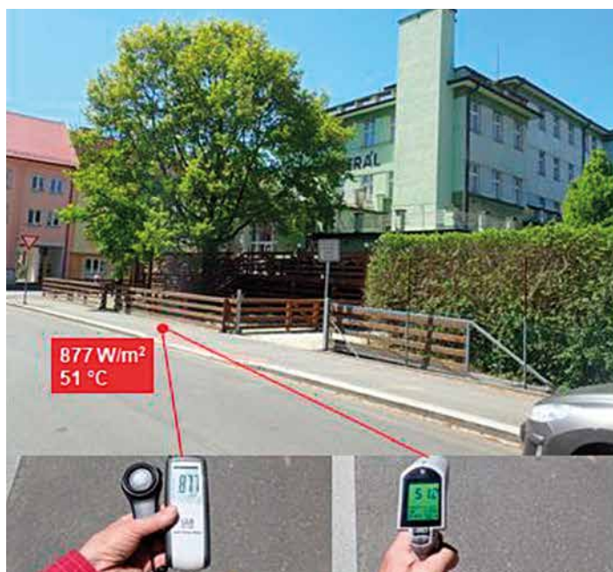
Obr. 2. Povrchové teploty a intenzitu slunečního záření lze snadno měřit cenově dostupnými přístroji. Intenzita slunečního záření na osluněném chodníku je 877 W.m -2 a povrchová teplota 51,2 °C. Ve stínu stromu je intenzita slunečního záření 82 W.m -2 a povrchová teplota 26,9 °C. Při transpiračním toku 20 litrů za hodinu chladí strom sebe a své okolí výkonem 14 kW. Sluneční energie uložená ve vodní páře se uvolní na chladných místech při srážení vodní páry zpět na vodu.
