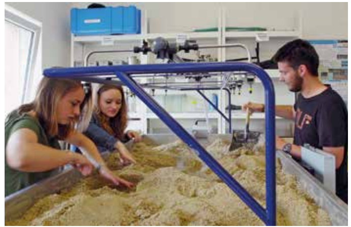
Obr. 6. Modelujeme tvorbu odtoku z povodí v hydraulické laboratoři
