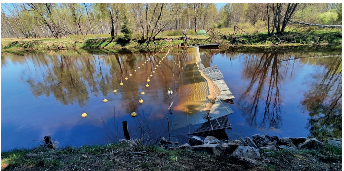
Obr. 3. Funkční prototyp bariéry při testování na Ovesné, žluté bóje nadnášejí elektrody bariéry Neptun Zdroj: VRV a.s.
