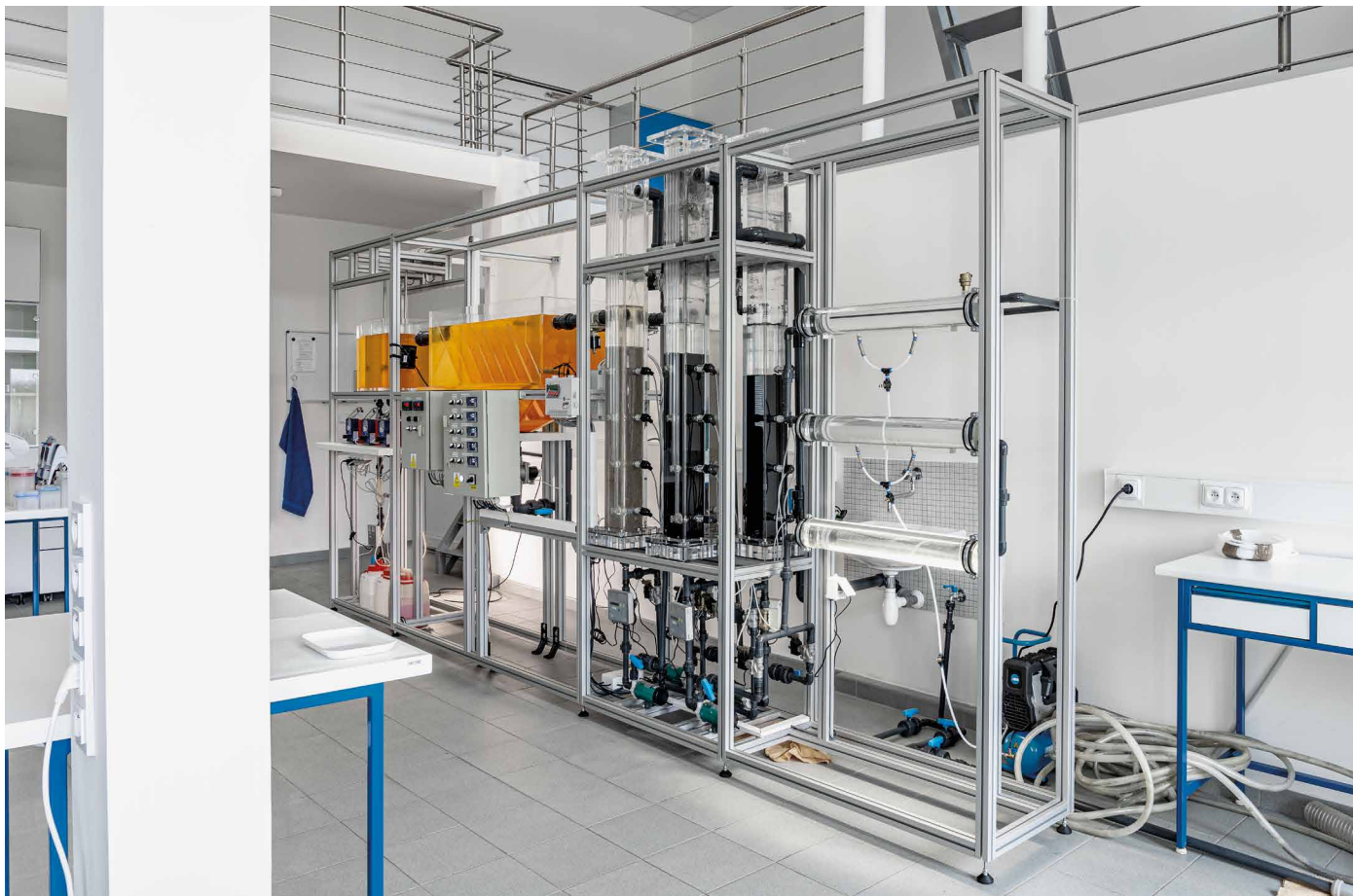
Obr. 3. Poloprovozní model úpravy vody s dvoustupňovou separací suspenze a adsorpcí na GAU
